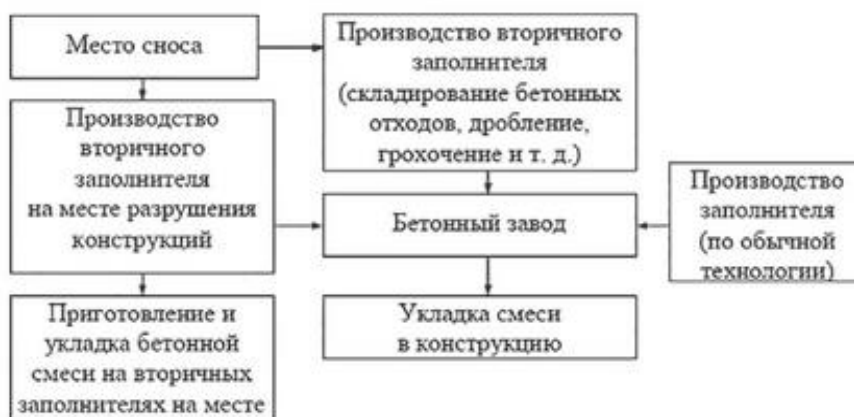
Рис. 15.2. Схема переработки и вторичного использования бетона
