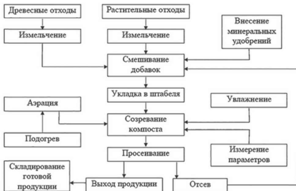
Рис. 15.10. Технологический процесс переработки древесно-растительных отходов
