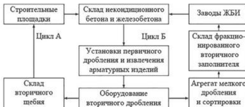
Рис. 15.1. Схема утилизации некондиционного бетона и железобетона
