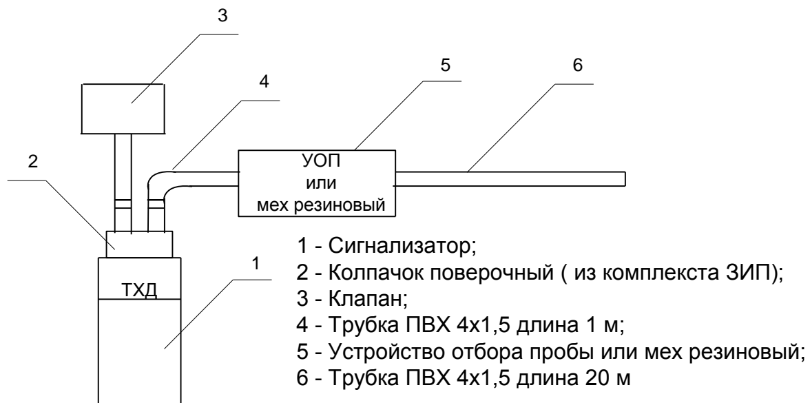
Рисунок 2.2 Схема подключения к сигнализатору СГГ-20 устройства отбора пробы (УОП) или меха резинового
