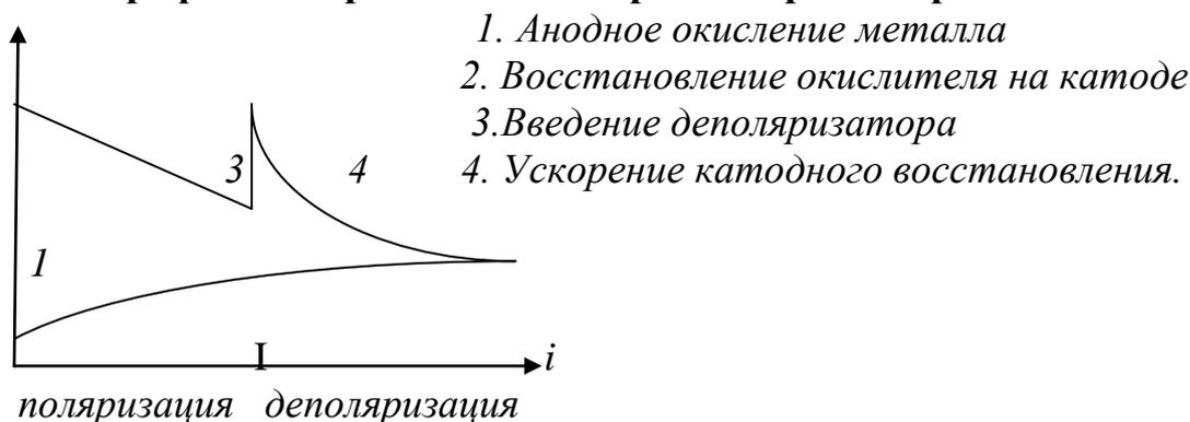
**Роль поляризации и деполяризации при электрохимической коррозии:** поляризация, возникающая в коррозионных гальванических элементах, снижает скорость коррозии, в то время, как введение деполяризатора стимулирует катодный процесс и ускоряет коррозионное разрушение.
