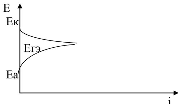
Коррозионный процесс протекает до тех пор, пока весь металл на аноде не разрушится. Поляризация в данном случае оказывает положительное значение, т.к. уменьшает силу коррозионного тока и снижает скорость коррозии.
