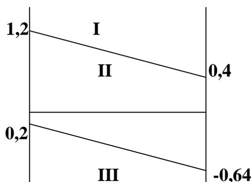
**Первая область** характеризуется  $E_{Me^{n+}/Me^0} > E_{O_2/OH}$ . Это характерно для золота и близких ему металлов. Для этих металлов коррозия кислородной и тем более водородной деполяризации невозможна.
