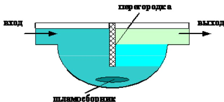
Рис. 3.2. Схема вертикальной песколовки
