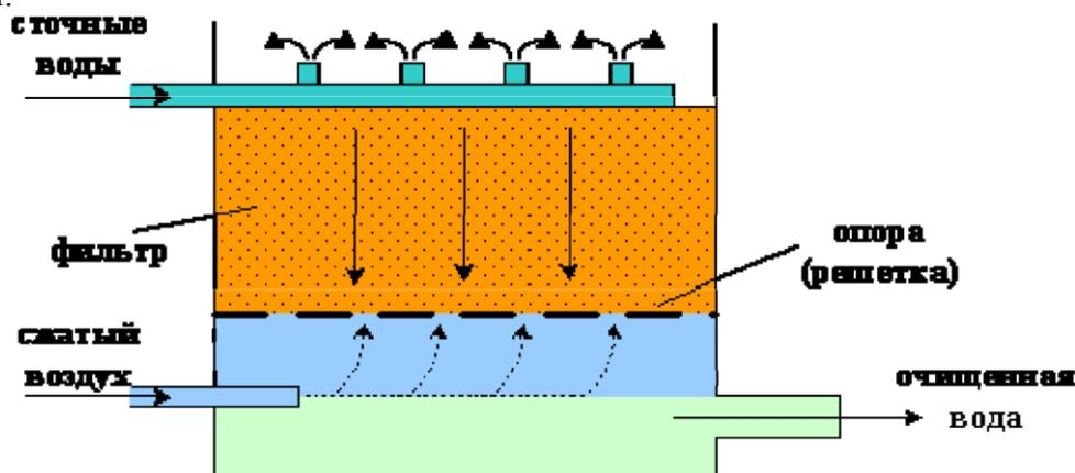
Рис. 3.6. Схема биофильтра
