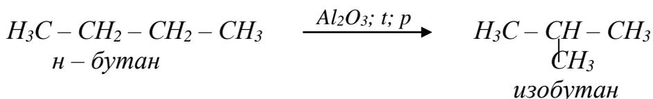
изобутан имеет более упорядоченную структуру, поэтому S уменьшается
