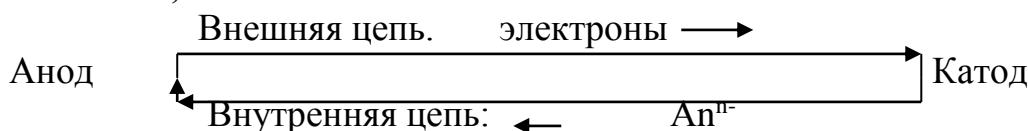
Внешняя цепь – металлический проводник (электронная проводимость).
