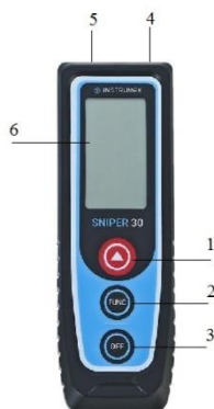
Рисунок 2.1 - Устройство лазерного дальномера
