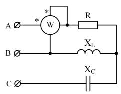
Определите показание ваттметра.
