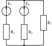
3. В цепи изображенной на рисунке:  $E_1 = 3$  B,  $E_3 = 6$  B,  $R_1 = 1$  Ом,  $R_2 = 2$  Ом,  $R_3 = 1$  Ом. Найдите токи  $I_1$ ,  $I_2$ ,  $I_3$ , используя метод контурных токов.
