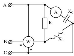
Определите показание ваттметра. Постройте топографическую диаграмму и определите из неё напряжение на входе цепи.
