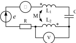
Определите показания приборов электромагнитной системы. Постройте векторнотопографическую диаграмму.
