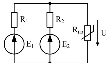
13. В цепи постоянного тока, изображенной на рисунке,  $R_1 = R_2 = 6 \Omega$ ,  $E = 12 \text{ В}$ . Симметричная ВАХ нелинейного элемента задана в виде таблицы. Определите напряжение на НЭ  $U$ .
