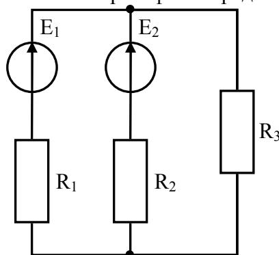
3. В цепи изображенной на рисунке:  $E_1 = 3 \text{ V}$ ,  $E_3 = 6 \text{ V}$ ,  $R_1 = 1 \Omega$ ,  $R_2 = 2 \Omega$ ,  $R_3 = 1 \Omega$ . Найдите токи  $I_1$ ,  $I_2$ ,  $I_3$ , используя метод контурных токов.
