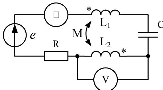
Определите показания приборов электромагнитной системы. Постройте векторно-топографическую диаграмму.
