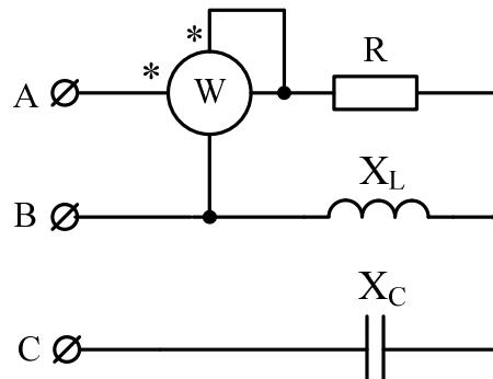
Определите показание ваттметра.
