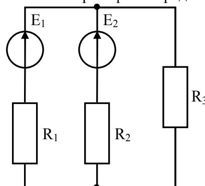
3. В цепи изображенной на рисунке:  $E_1 = 3$  В,  $E_3 = 6$  В,  $R_1 = 1$  Ом,  $R_2 = 2$  Ом,  $R_3 = 1$  Ом.
