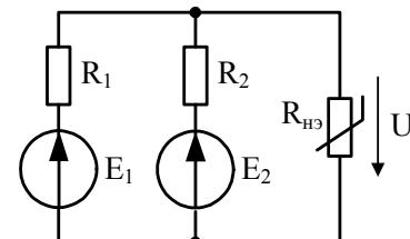
13. В цепи постоянного тока, изображенной на рисунке,  $R_1 = R_2 = 6$  Ом,  $E = 12$  В. Симметричная ВАХ нелинейного элемента задана в виде таблицы. Определите напряжение на НЭ  $U$ .
