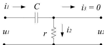
2. По представленной схеме устройства составить уравнения динамики и, перейдя к операционной форме записи, получить передаточную функцию для указанных входного и выходного сигналов.
