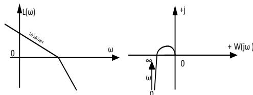
12. По графику  $L(\omega)$  построить на основании теоремы Боде приближенный график  $\varphi(\omega)$ , а затем по двум графикам дать амплитудно-фазовую характеристику устройства (качественно).
