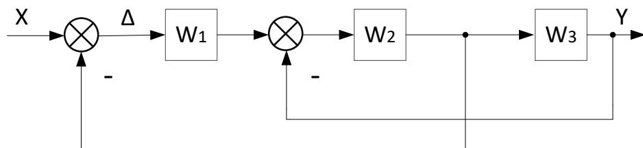
4. Установить связь между сигналами  $X$  и  $Y$  по структурной схеме, используя правила преобразования структурных схем для операционной формы записи уравнений.
