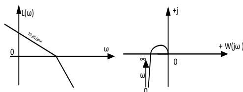
12. По графику  $L(\omega)$  построить на основании теоремы Боде приближенный график  $\varphi(\omega)$ , а затем по двум графикам дать амплитудно-фазовую характеристику устройства (качественно).
