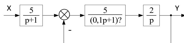
15. С помощью критерия Найквиста для логарифмических частотных характеристик, оценить устойчивость САР, используя соответствующую структурную схему.
