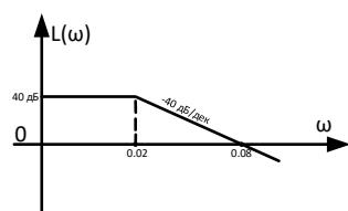
13. По графику  $L(\omega)$  записать передаточную функцию устройства.
