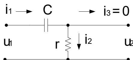
2. По представленной схеме устройства составить уравнения динамики и, перейдя к операционной форме записи, получить передаточную функцию для указанных входного и выходного сигналов.
