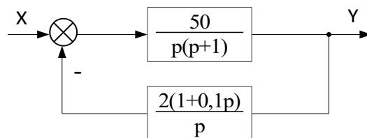
16. С помощью критерия Найквиста для логарифмических частотных характеристик, оценить устойчивость САР, используя соответствующую структурную схему.
