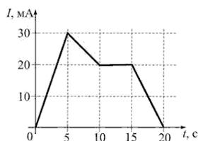
мени в электрической цепи с индуктивностью 1 мГн. Модуль среднего значения ЭДС самоиндукции в интервале от 0 до 5 с (в мкВ) равен...
