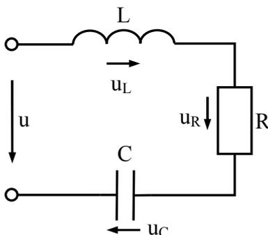
7. В цепи изображенной на рисунке определите характер цепи (активно-емкостной или активно-индуктивный), а также токи в ветвях, если  $U = 100\sin 314t \text{ В}$ ,  $R = 100 \text{ Ом}$ ,  $X_C = 60 \text{ Ом}$ ,  $X_L = 30 \text{ Ом}$ .
