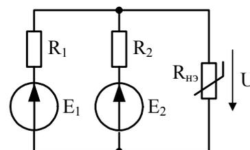
13. В цепи постоянного тока, изображенной на рисунке,  $R_1 = R_2 = 6$  Ом,  $E = 12$  В. Симметричная ВАХ нелинейного элемента задана в виде таблицы. Определите напряжение на НЭ  $U$ .
