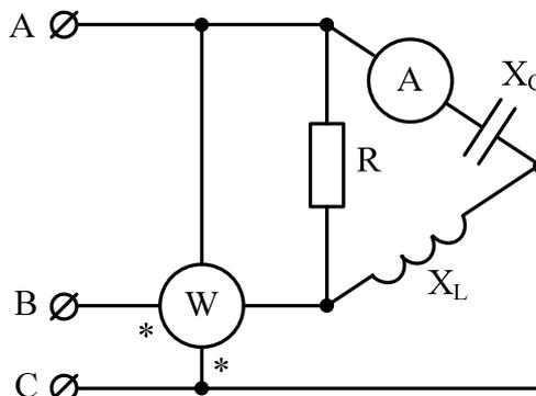
Определите показание ваттметра. Постройте топографическую диаграмму и определите из неё напряжение на входе цепи.
