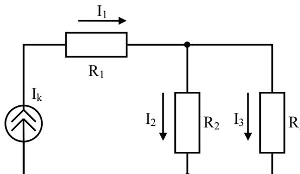
2. Для цепи изображенной на рисунке:  $E_1 = 3$  В,  $E_2 = 6$  В,  $R_1 = 1$  Ом,  $R_2 = 1$  Ом,  $R_3 = 2$  Ом. Составить систему уравнений по законам Кирхгофа и определить все токи в цепи.
