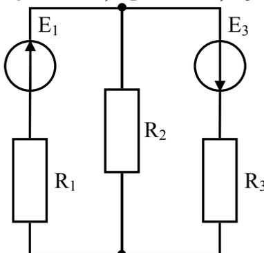
5. В схеме представленной на рисунке  $E_1 = 3 \text{ В}$ ,  $E_2 = 6 \text{ В}$ ,  $I_a = 2 \text{ А}$ ,  $I_c = 3 \text{ А}$ ,  $I_d = 2 \text{ А}$ ,  $R_1 = 3 \text{ Ом}$ ,  $R_2 = 4 \text{ Ом}$ ,  $R_3 = 2 \text{ Ом}$ . Определите напряжение  $U_{ab}$  между узлами  $a$  и  $b$ , приняв потенциал узла  $b$  равным нулю. Постройте потенциальную диаграмму.
