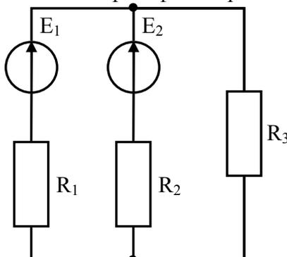
3. В цепи изображенной на рисунке:  $E_1 = 3$  В,  $E_3 = 6$  В,  $R_1 = 1$  Ом,  $R_2 = 2$  Ом,  $R_3 = 1$  Ом. Найдите токи  $I_1$ ,  $I_2$ ,  $I_3$ , используя метод контурных токов.
