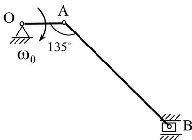
26. Определить скорость точки В колеса, если точка А имеет скорость  $V_A = 1\text{ м/с}$ .
