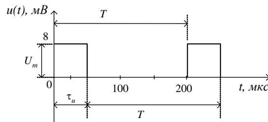
1.3. По заданному графику периодической последовательности прямоугольных радиоимпульсов (ППРИ) определить ее параметры: амплитуду, длительность импульсов, период и частоту следования импульсов, период и частоту несущего колебания, начальную задержку и начальную фазу.
