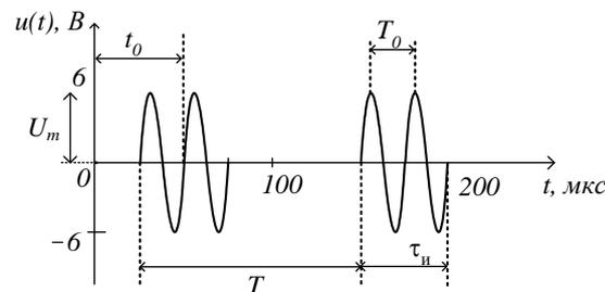
1.4. По заданному графику периодической последовательности экспоненциальных видеоимпульсов (ППЭВИ) определить их параметры: амплитуду, длительность импульса (по половинному уровню), длительность фронта и спада (по уровням 0,1 и 0,9 от амплитуды), период (и частоту) следования импульсов.
