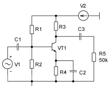
2. Графоаналитическим методом рассчитать параметры компонентов для задания режима по постоянному току, обеспечивающего получение максимальной амплитуды выходного напряжения. Напряжение питания 15 В.
