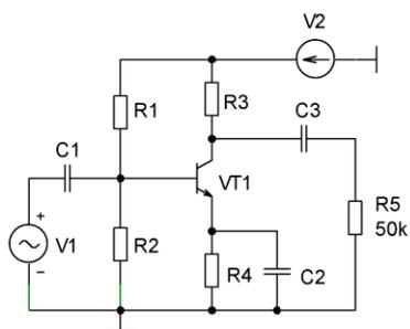
1. Приближенным методом рассчитать параметры компонентов для задания режима по постоянному току, обеспечивающего получение максимальной амплитуды выходного напряжения. Напряжение питания 10 В, коэффициент передачи тока транзистора  $\beta=50\dots 100$ .
