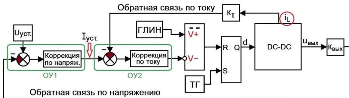
Рисунок 2 – Структурная схема замкнутой системы управления dc-dc-преобразователем с обратной связью по среднему току
