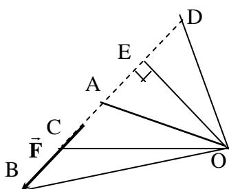
5. К вершине А прямоугольной пластины, длины сторон которой  $a=0,4 \text{ м}$ ,  $b=0,3 \text{ м}$ , приложена сила  $F=20 \text{ Н}$ . Определить алгебраическую величину момента этой силы относительно точки В.
