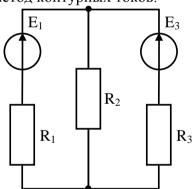
4. Используя метод контурных токов, определить токи в ветвях схемы, изображенной на рисунке 2, если  $E_1=4~B,\,E_3=6~B,\,R_1=20~Om,\,R_2=40~Om,\,R_3=20~Om.$
