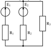
3. В цепи изображенной на рисунке:  $E_1 = 3$  B,  $E_3 = 6$  B,  $R_1 = 1$  Ом,  $R_2 = 2$  Ом,  $R_3 = 1$  Ом. Найдите токи  $I_1$ ,  $I_2$ ,  $I_3$ , используя метод контурных токов.
