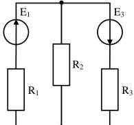
5. В схеме представленной на рисунке  $E_1 = 3$  В,  $E_2 = 6$  В,  $I_a = 2$  А,  $I_c = 3$  А,  $I_d = 2$  А,  $R_1 = 3$  Ом,  $R_2 = 4$  Ом,  $R_3 = 2$  Ом. Определите напряжение  $U_{ab}$  между узлами a и b, приняв потенциал узла b равным нулю. Постройте потенциальную диаграмму.
